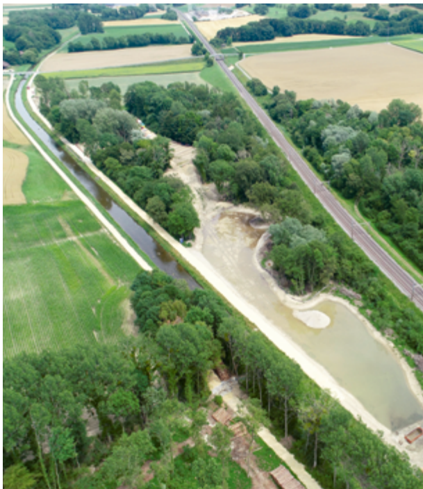
Entre Penthalthaz et Lussery-Villars, un chantier sur la Venoge a vu la création d'un bras de rivière d'environ 600 m traversant la forêt alluviale de Bois-de-Vaux.
