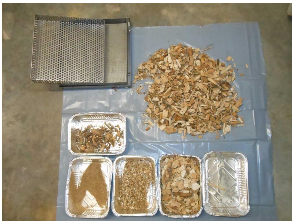
Figure 2 : Plaquettes livrées (tas) et fractions après tamisage (source: EBS)
