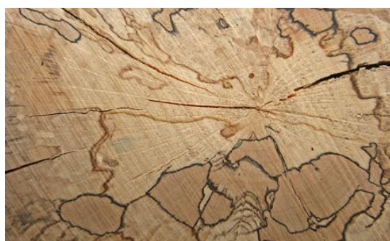
Figure 1: Echauffures sur le bois de l'hêtre (source publique)
