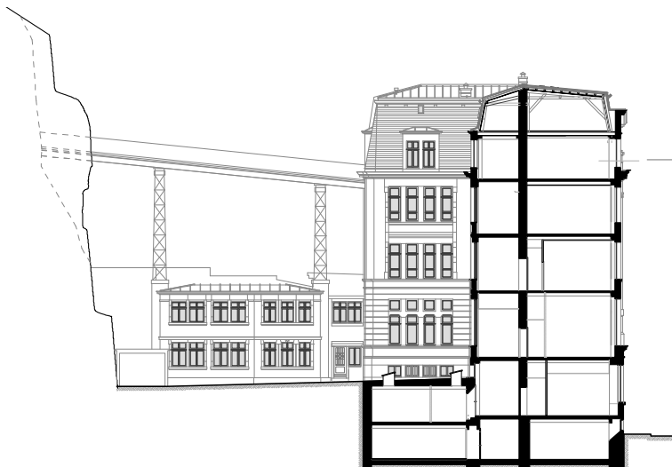
coupe transversale – façade nord de l'annexe
