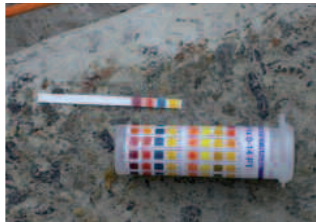
Bandelettes utilisées pour le contrôle rapide du pH d'un effluent.
