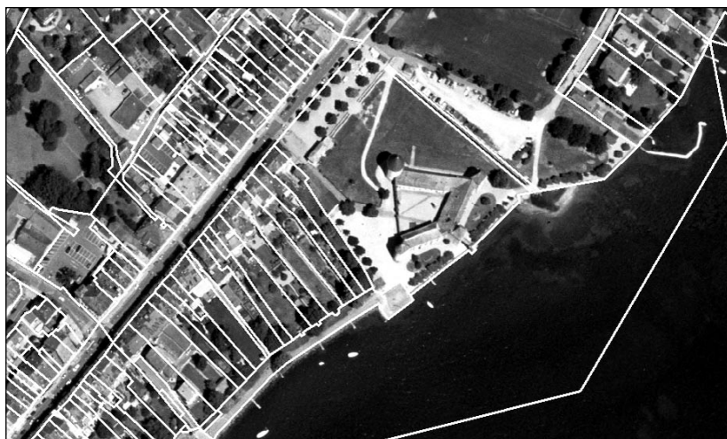
Un exemple de géodonnées: photographie aérienne (orthophoto) sur laquelle sont superposées les limites des parcelles cadastrales (établies sur la base des données du cadastre).
