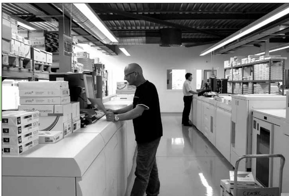
Au premier plan, l'opérateur Gilbert Hefti, près des deux lignes d'impression Xerox, capables d'imprimer jusqu'à 288 pages par minute.
