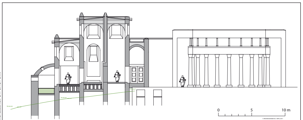
Coupe restituée sud-nord en travers des thermes de la villa et du pavillon en hémicycle le plus méridional.
