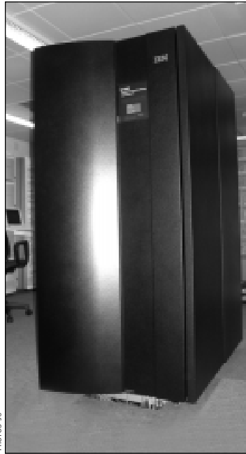
Le serveur central IBM S/390 et ses entrailles. Cette machine ne déménage pas, mais toutes les données sensibles qui y transitaient seront désormais traitées à Berne par un IBM Z/37, serveur similaire mais plus performant.
