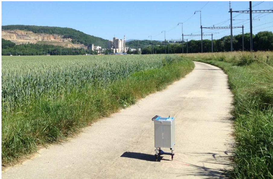
Figure 5 – Exemple d’acquisition gravimétrique, avec un appareillage léger
