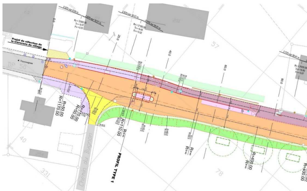
Figure 11 – îlot de séparation après la traversée du village de Treycovagnes (partie en localité du projet)
