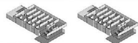
COLLECTION PERMANENTE Les galeries permanentes sont modulables pour pouvoir installer des espaces allant du plus intime (8.3x8.3m) au plus grandiose (8.3x40m).
