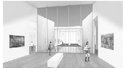
Au niveau supérieur, les deux parties et une paroi en verre translucide revêtue côté nord donnent une ambiance lumineuse et complètent le dispositif. Des stores extérieurs sont prévus sur le vitrage sud des parties. Les galeries dirigent également la lumière naturelle vers les galeries d'expositions temporaires en rez-de-chaussée.
