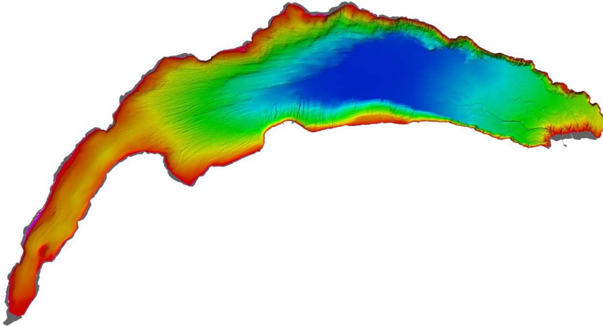
Sonar multifaisceaux (Kongsberg 2040) avec un émetteur acoustique à 400 points de sondage par « ping » (signal émis) jusqu'à une profondeur maximale théorique d'environ 500 mètres
