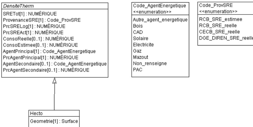
Figure 2: Diagramme de classe UML des zones potentielles aux réseaux thermiques
