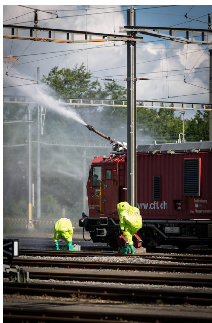
Pompiers munis de tenue lourde étanche et rideau d'eau déployé par le train d'extinction et de secours des CFF (TES) pour contenir la propagation du chlore
