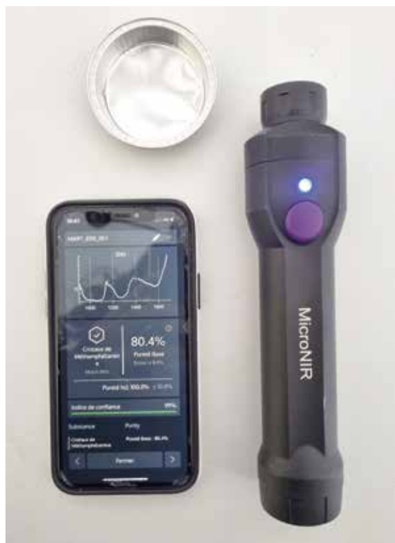
Un petit spectromètre, de la taille d'une lampe-torche permet d'analyser un produit stupéfiant en quelques secondes. Les résultats se lisent sur le portable qui complète l'équipement.
