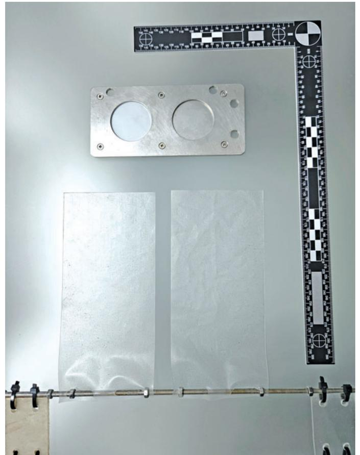
En haut, les capteurs de type POCIS (une plaque métallique composée d'une zone de calibrage et d'une zone de récolte des données) permettent de cibler des composés tels que les pesticides.
