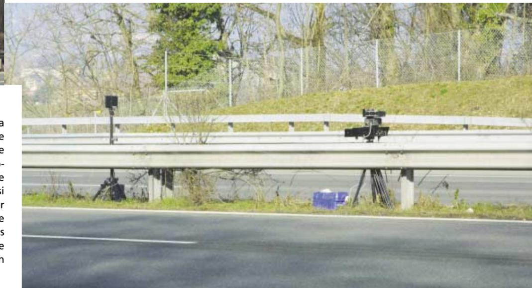
discrètement filmé par la caméra numérique du radar, depuis une distance de plusieurs centaines de mètres déjà, et ce jusqu'à l'interception. Ce procédé a l'avantage d'une plus grande précision de mesure, si bien que les déductions faites, pour la marge d'erreur, sont réduites de 2 km/h, par rapport aux autres appareils. En outre, il peut être parfaitement discret, suivant son emplacement.
