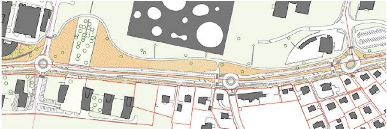
**Figure 5** : les trois futurs giratoires appelés à structurer l'accessibilité de ce tronçon de la RC 1
