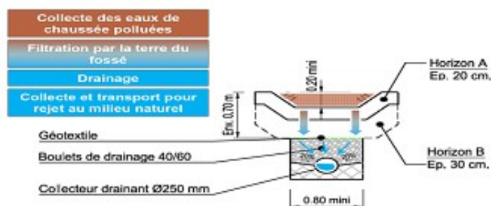
Fossé de filtration
