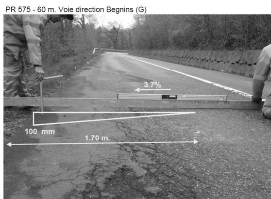
Figure 3 : Déformations du talus aval, mesures de terrain, en arrière-fond mur en blocs de béton
