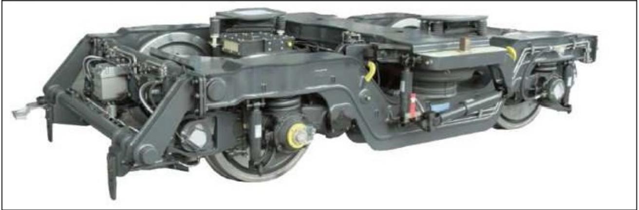
**Le bogie est l'élément de liaison entre le châssis du train et la voie ferrée. Composé de deux essieux, il intègre les moteurs de traction et le système de freinage du train. Il assure également la suspension de la caisse.**
