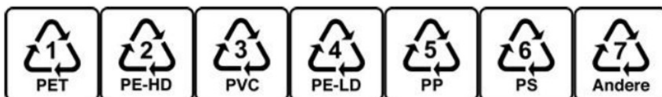
Fig. 1 : Codes d'identification des résines plastiques utilisées pour les emballages
