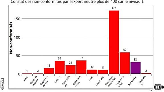
Constat des non-conformités par l'expert neutre plus de 400 sur le niveau 1
