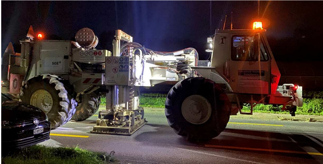
Figure 4 – Camion vibreur utilisé pour l’acquisition d’imagerie sismique, on observe au centre du véhicule une plaque vibrante qui produit le signal enregistré par des appareils appelés géophones
