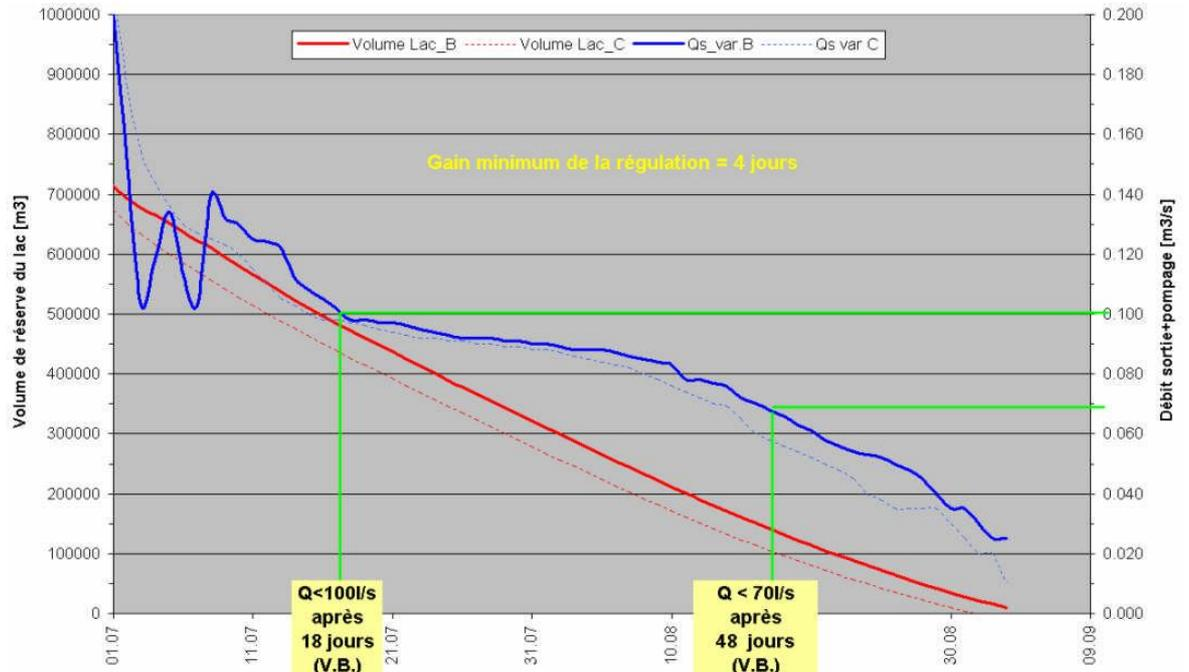
Figure 17: volume de réserve et débit de sortie du lac – situation variante B
