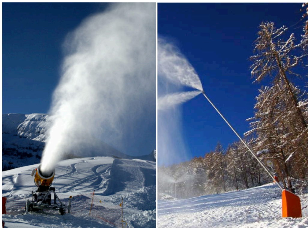
Figure 4.2.10 : Enneigeurs à basse pression (à gauche) et à haute pression (à droite)
