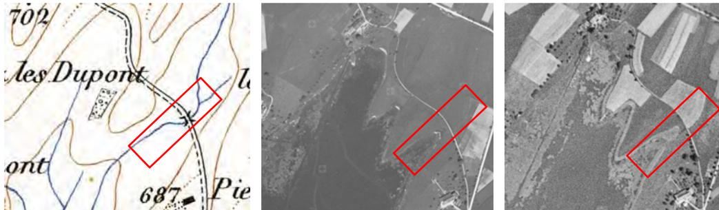
Figure 2. L'écoulement à ciel ouvert, bien visible sur la carte Siegfried (fin du 19<sup>ème</sup> à gauche), déjà mis sous terre en partie en 1939, est complètement enterré en 1946 (à droite).
