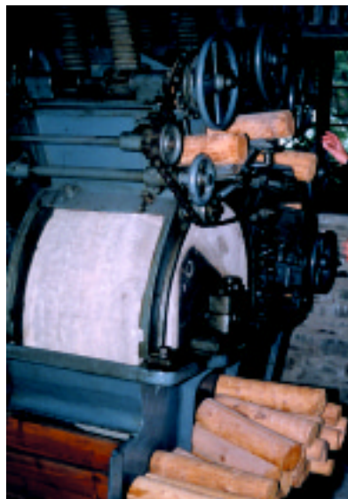
Mit Hilfe eines Steinschleifers wird Holzschliff für holzhaltige Papiere hergestellt.
