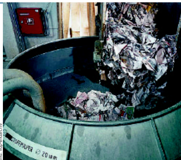
Im Stofflöser («Pulper») wird Altpapier aufgelöst. Der so gewonnene Altpapierstoff dient als Grundlage zur Herstellung von Recyclingpapier.
