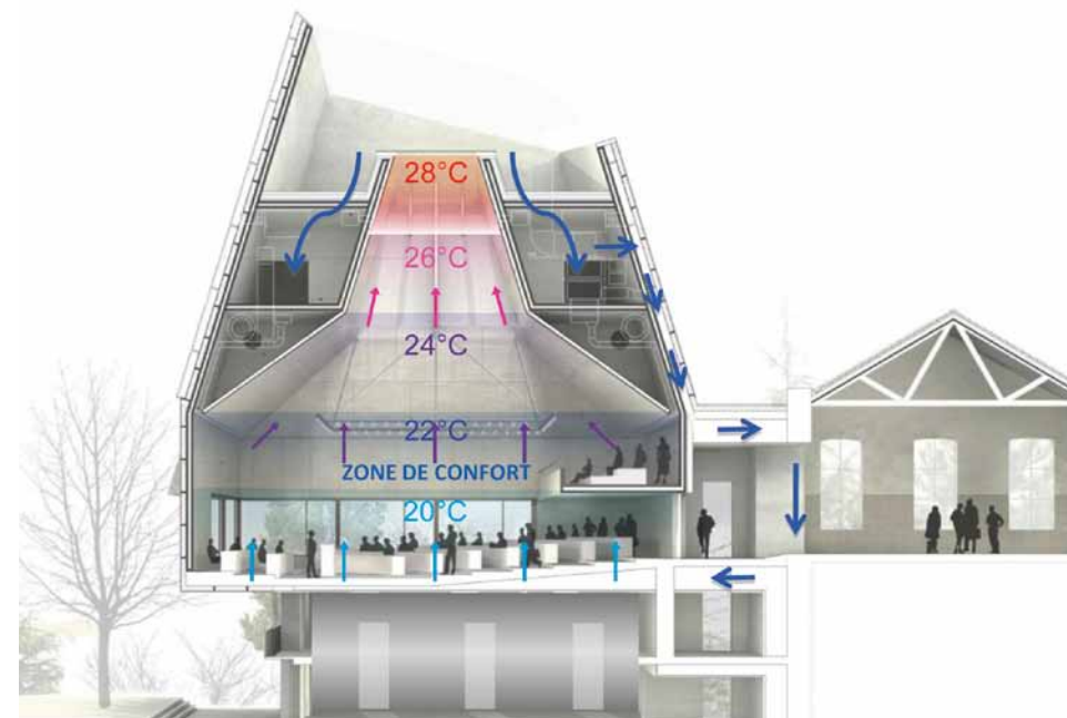
Figure 16: Schéma du toit et de la gestion climatique de la salle parlementaire
