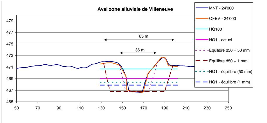
Annexe 4.1 - Largeurs et profondeurs d'équilibre (d50=50mm et d50=1mm)
