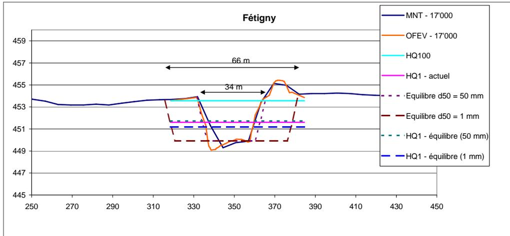
Annexe 4.1 - Largeurs et profondeurs d'équilibre (d50=50mm et d50=1mm)
