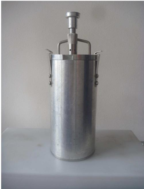
Figure 2 : Bouteille de prélèvement d'eau
