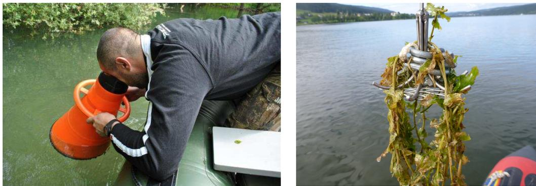
Figure 3.1. Aquascope (gauche) et grappin (droite) utilisés pour l'observation et le prélèvement des plantes aquatiques submergées.
