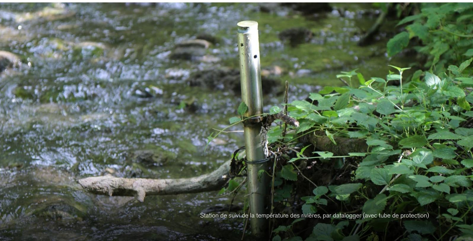
Station de suivi de la température des rivières, par datalogger (avec tube de protection)
