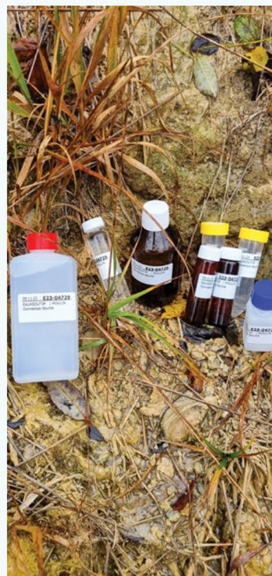
Sur le terrain, les inspecteurs de l'environnement utilisent une canne télescopique équipée d'un bécquet pour pouvoir prélever l'eau dans des endroits difficilement accessibles. L'échantillon est ensuite réparti dans des flacons différents (plastique ou verre) selon les analyses prévues, pour maintenir la représentativité et l'intégrité de chaque échantillon.
