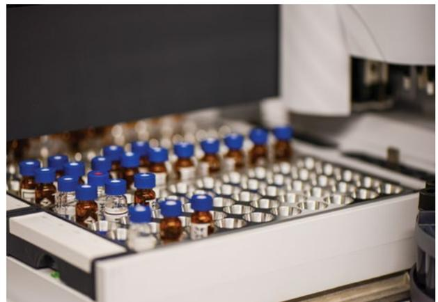
L'analyse des micropolluants nécessite des instruments de haute technologie garantissant la sensibilité et la spécificité de cette analyse. Ici, des échantillons spécialement préparés dans des petits flacons vont être injectés dans une chromatographie liquide couplée à une spectrométrie de masse pour l'analyse des pesticides.
