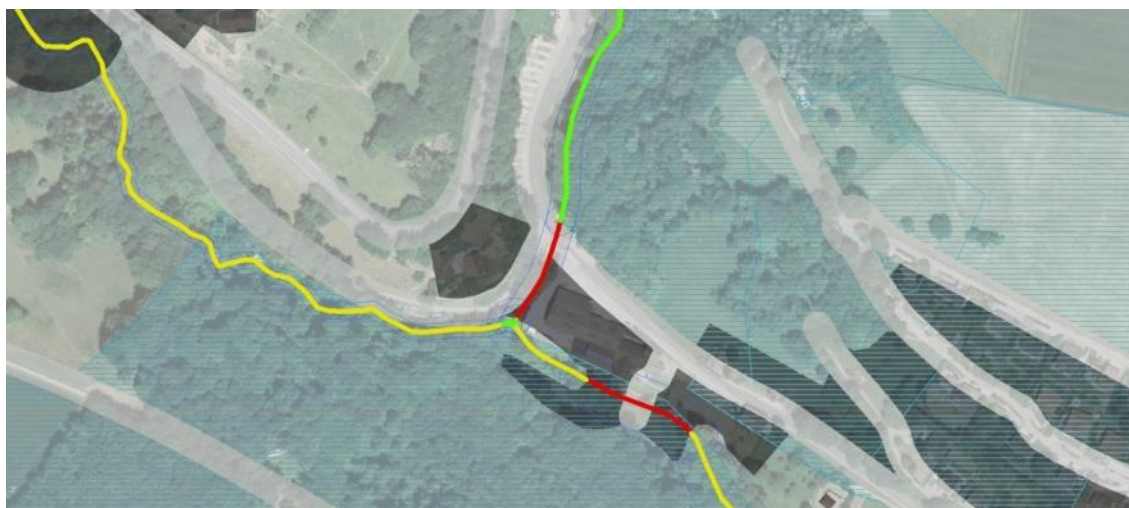
Figure 7. Exemple de l'évaluation de l'importance des installations par sous-tronçons (croissante du vert au rouge). En noir = zones bâties, en gris = routes, hachures bleues = zone de protection des eaux.
