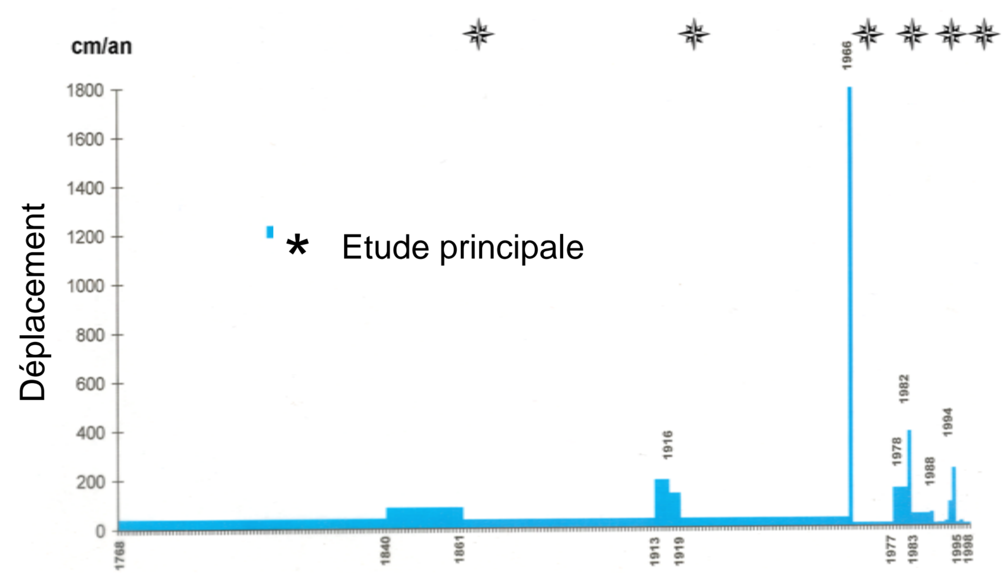
Glissement de la Frasse: Déplacement annuel depuis 1768
