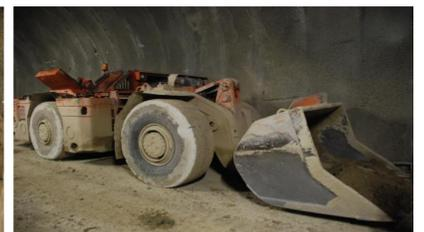
La **phase de marinage** nécessite environ 2½ heures. La capacité des godets des chargeuses est de 4.5m<sup>3</sup>. 30 voyages sont donc nécessaires pour sortir les 130m<sup>3</sup> de déblai d'excavation au portail. 35'000m<sup>3</sup> de déblais d'excavation ont été ainsi déposés dans la carrière au Plan Champ qui se situe à 800m en aval du chantier. Ces matériaux seront utilisés lors du réaménagement définitif de la carrière.
