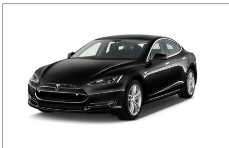
Pour la première fois livrée en Europe en 2013, la **Tesla Model S** est la toute première berline de luxe commercialisée par le constructeur Tesla Motors. Ce dernier propose 5 tailles de batterie (60, 75, 85, 90 et 100 kWh) et deux modes propulsion (deux roues ou 4x4). L'autonomie du modèle est très étendue (400 à 600 km<sup>15</sup>) et ses performances sont dignes d'une sportive thermique (0 à 100 km/h entre 2,4 à 5,5 secondes).
