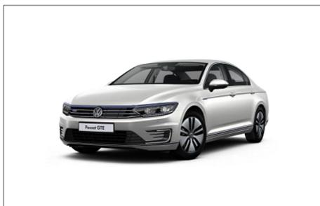
La **VW Passat GTE**, est le deuxième VHR de la gamme du constructeur qui entre avec ce modèle sur le marché des berlines VHR en 2015. Plus puissante que la Golf GTE, elle est aussi plus gourmande, avec une consommation en mode hybride à 2,0 l/100km (essence) et des émissions de CO2 de 45 g/km. Sa vitesse de pointe est de 225 km/h, avec un 0 à 100 km/h abattu en 7,4 secondes.
