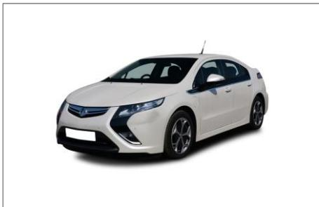
L'**Opel Ampera**<sup>17</sup> est le premier véhicule électrique à autonomie étendue à être commercialisé en Europe dès 2011. Sa batterie de 16 kWh lui permet de rouler 60km en tout électrique avant que le moteur thermique de 86ch n'intervienne pour recharger la batterie. Le 0 à 100 est réalisé en 9 secondes et sa vitesse maximale est de 160 km/h. Son faible succès a conduit à l'arrêt de sa commercialisation fin 2016.
