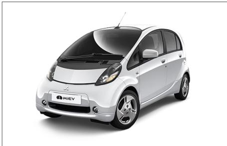
La **Mitsubishi i-Miev**<sup>16</sup> est une mini-citadine commercialisée pour la première fois au Japon en 2009. Sa batterie de 16 kWh lui confère une autonomie d'environ 160 km<sup>15</sup>. Son petit moteur électrique de 47 kW limite sa vitesse maximale à 130 km/h ainsi que son accélération : le 0 à 100 km/h est réalisé en environ 15 secondes.
