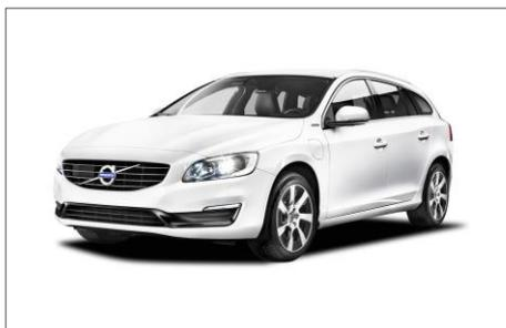
Commercialisé dès 2012, la **Volvo V60 Plug-In** est le premier VHR diesel au monde, et constitue l'entrée du groupe sur le marché de la mobilité électrique. Bien que développant au total 204ch, en mode hybride sa consommation n'est que de 1,8 l/100 km (gazole) et les émissions de CO<sub>2</sub> se limitent à 48 g/km. Sa vitesse maximale est de 230 km/h et elle effectue le 0 à 100 km/h en 6,1 secondes.
