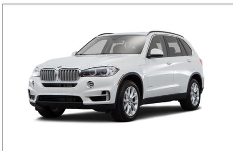
La **BMW X5 40e** a été la première VHR du constructeur, commercialisée dès 2015. Ce SUV basé sur la BMW X5 développe 313 ch avec des performances très correctes pour le segment : vitesse de pointe à 210 km/h et un 0 à 100 km/h réalisé en 6,8 secondes. En mode hybride il ne consomme que 3,3 l/100km en moyenne, avec des émissions de CO2 à tout de même 77g/km.
