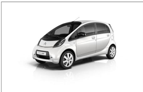
La **Citroën C-Zero** est déclinée de la Mitsubishi i-Miev. Elle possède donc les mêmes caractéristiques techniques, à savoir une vitesse maximale d'environ 130 km/h et un 0 à 100 réalisé en environ 15 secondes. Sa batterie est toutefois légèrement plus petite que celle de la i-Miev avec 14,5 kWh à bord, ce qui lui confère une autonomie de 150 km<sup>15</sup>.
