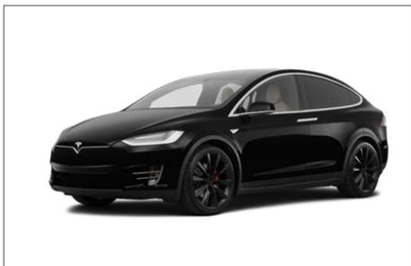
Deuxième modèle du constructeur Tesla, la **Model X** est un SUV de luxe commercialisé aux Etats-Unis en 2015. Elle est disponible en 3 tailles de batterie (75, 90 et 100 kWh) et un unique mode de propulsion (4x4). L'autonomie du modèle est très étendue (400 à 500 km<sup>15</sup>) et ses performances sont dignes d'une sportive thermique (0 à 100 km/h entre 3 à 6 secondes).
