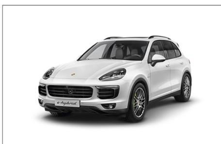
La **Porsche Cayenne S eHybrid** apparue en 2014 est la version « propre » du SUV sportif du groupe. Il s'agit du deuxième modèle VHR du groupe, l'autre étant la Panamera S eHybrid. Ce SUV développe 380 chevaux pour une vitesse maximale de 243 km/h et un 0 à 100 km/h effectué en 5,9 secondes. Il offre aussi la possibilité en mode hybride de limiter la consommation à 3,4 l/100km (essence) en émettant tout de même 74 gCO<sub>2</sub>/km.
