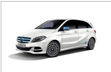
La **Mercedes-Benz B 250 e**, est le premier VE de la marque. Sa batterie de 28 kWh lui confère une autonomie d'environ 130 km<sup>15</sup>, ce qui est relativement faible comparé aux autres VE. Cependant, son moteur de 136 kW développé par Tesla Motors lui accorde une vitesse maximale de 160 km/h et lui permet d'effectuer le 0 à 100 km/h en 7,9 secondes.
