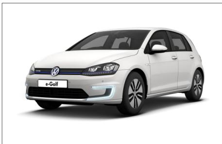
La **VW e-Golf**, est le deuxième véhicule électrique du constructeur, commercialisé dès 2014. Sa batterie de 24,2 kWh lui confère une autonomie de 190 km<sup>15</sup>. Sa vitesse de pointe est d'environ 150 km/h et le 0 à 100 km/h est réalisé en un peu plus de 9 secondes. Une nouvelle version avec une batterie de 35,8 kWh et une autonomie jusqu'à 300km<sup>15</sup> est attendue au printemps 2017.
