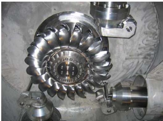
**Figure 15. Roue de turbine Pelton**
