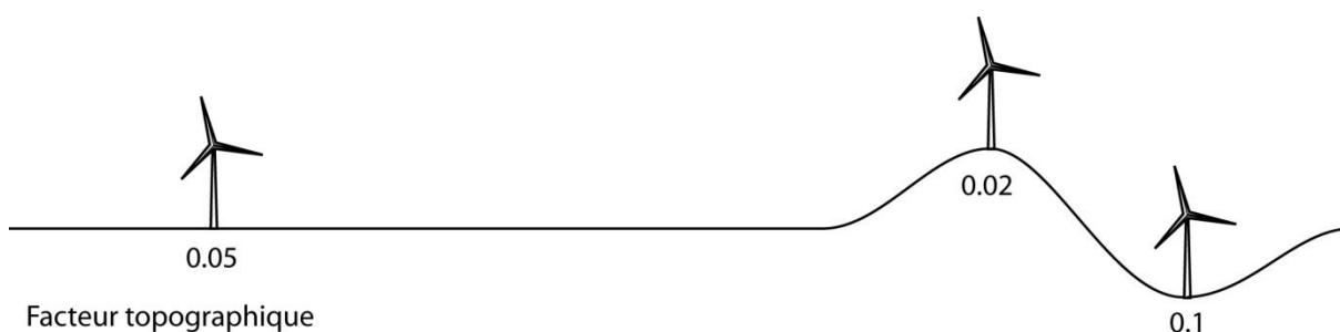
Fig. 33. Illustration des trois cas de figure retenus pour le facteur topographique: éolienne en situation sommitale ( p_{topo} = 0,02 ); éolienne sur un plateau ou en plaine ( p_{topo} = 0,05 ); éolienne dans une dépression (vallée, combe; p_{topo} = 0,1 ).
