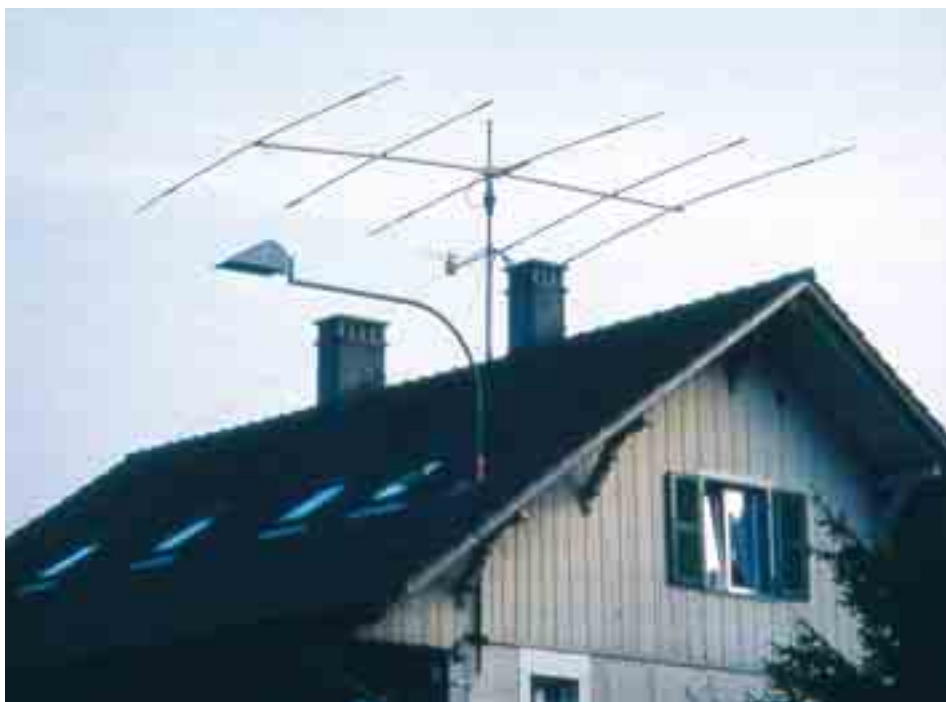
Il existe une grande diversité d'antennes radioamateurs de formes très différentes. Celle représentée ici est une antenne de toit de « type Yagi ».
