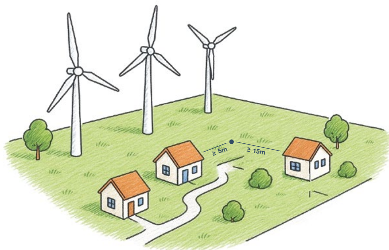
Figure 1 : Exemple de placement du sonomètre
