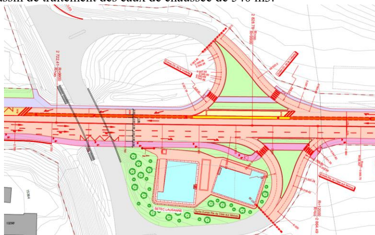
Figure 7 - Système d’évacuation et de traitement des eaux de chaussée (SETEC) de Lausanne
