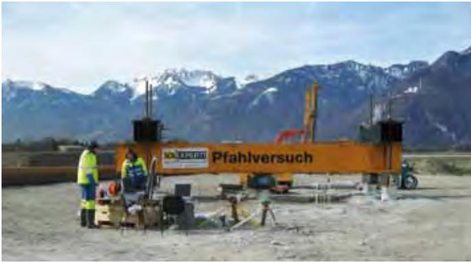
Essai de charge pour les pieux Vibrex du viaduc sur l'A9 en mars 2010
