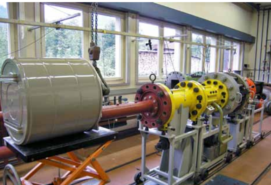
Test de résistance aux variations de pression sur un filtre à gaz.
