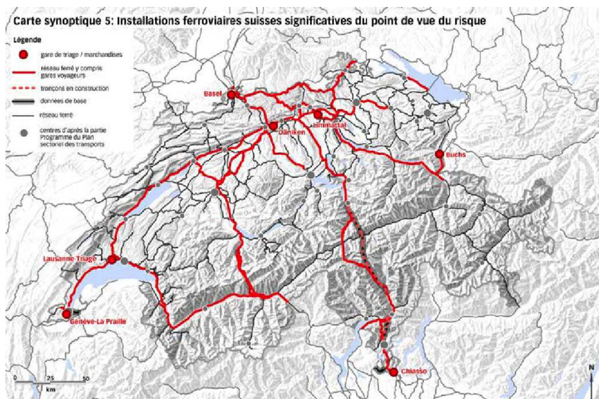
Figure 5.24 Installations ferroviaires significatives sous l'angle des risques du point de vue de l'aménagement du territoire en Suisse
