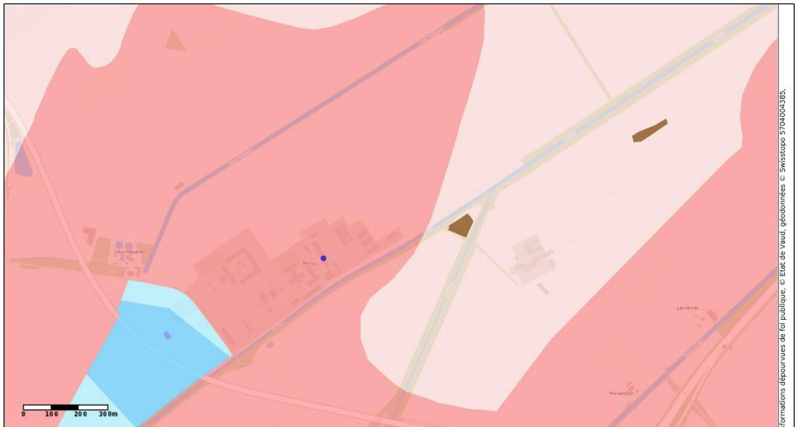
Figure 3 : Secteur du projet concerné par des zones de protection des eaux. En bleu-foncé, la zone S2 ; en bleu-clair, la zone S3 ; en rouge foncé, la zone Au ; en clair, la zone üB. En brun, les deux zones recensées comme sites pollués sans nécessités de surveillance ou d'assainissement.
