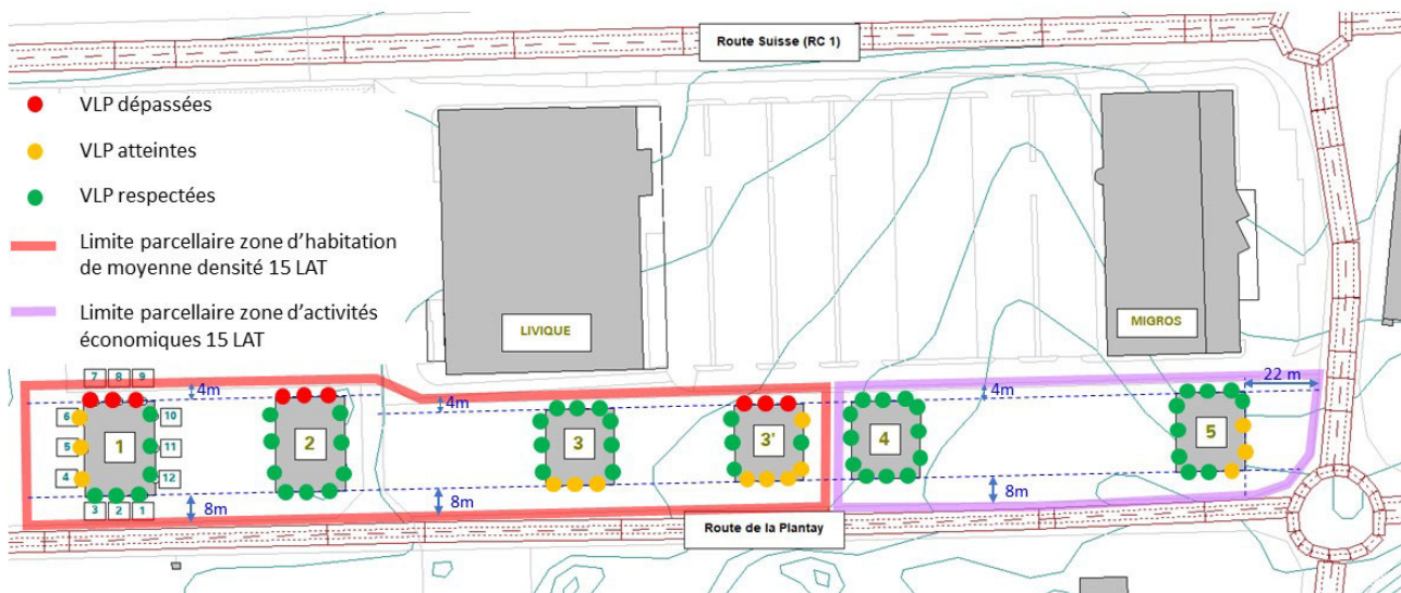
Situation des points d'évaluation des immissions de bruit routier avec numéro de point correspondant pour les bâtiments fictifs
