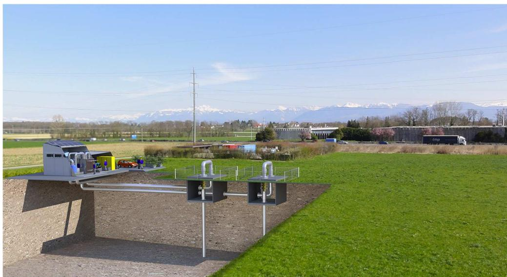
Figure 5 : Illustration des installations de surface restantes pour un doublet géothermique - système hydrothermal (source : [www.energeo.ch](http://www.energeo.ch)).
