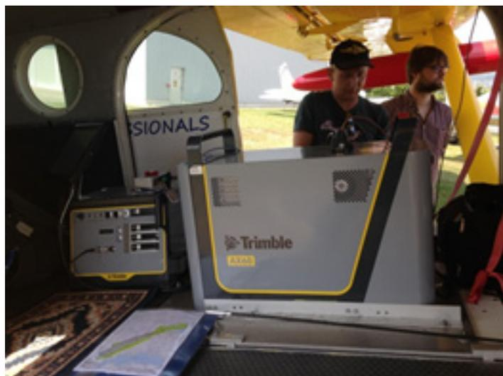
A gauche, le pilatus PC-6 de la société Swissboogie qui a réalisé les vols. A droite, l'image du système LiDAR Trimble AX60 de la société BSF Swissphoto
