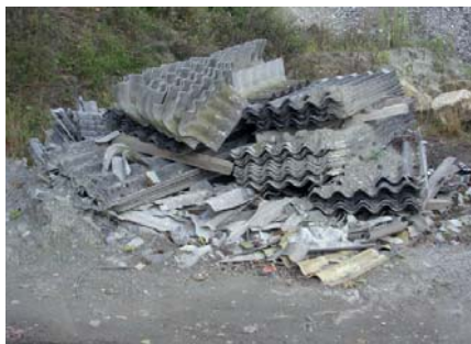
Ce type de plaques ondulées contient souvent de l'amiante! Photo: Florian P. Zellweger / SESA
